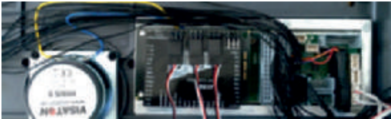
G-Spur „Allegra“ (RhB ABe) nach Aufstecken des Decoders MX699LS (in die Original 2x14-polige Märklin-Schnittstelle). Da die analoge Lok keine Panto-Antriebe besitzt, wurden drei Servos eingebaut und mit den Servo-Anschlüssen des MX699LS verbunden.
