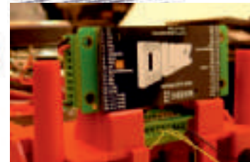
Standardmäßiger Großbahn-Sound-Decoder MX696KS, eingebaut in der PIKO BR 64.
