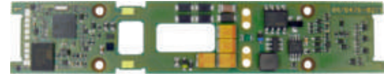
Beispiel: Lok-spezifischer Sound-Decoder für eine N-Spur Re 460
