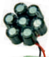
Beispiel unten: Großbahn-Decoder mit Goldcap-Modul
